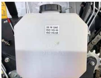
Réservoir de lubrification des chaînes grande capacité.
