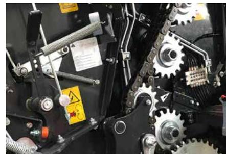
Des chaînes 1¼" de type HBC sont utilisées pour l'entraînement de la chambre de pressage et du rotor.
