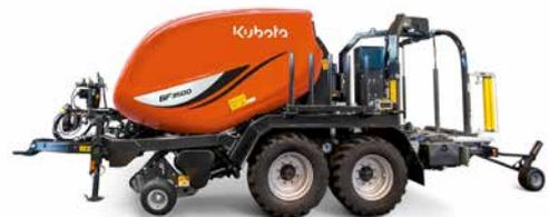
Stockage de 10 rouleaux de film de recharge abaissé hydrauliquement.
