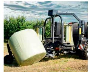
Option de vire balle. Pendant le transport, il est automatiquement déplacé en position route sous l'enrubanneuse.
