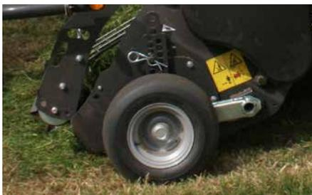
Roues de jauge avec réglage simple de la hauteur de ramassage.
