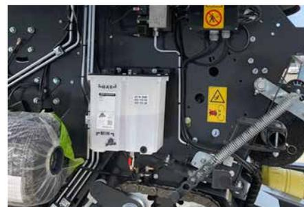
Flexibles rigides en acier pour le circuit hydraulique.
