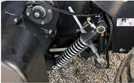
Relevage hydraulique du pick-up avec système de suspension intégré pour un suivi précis du terrain.
